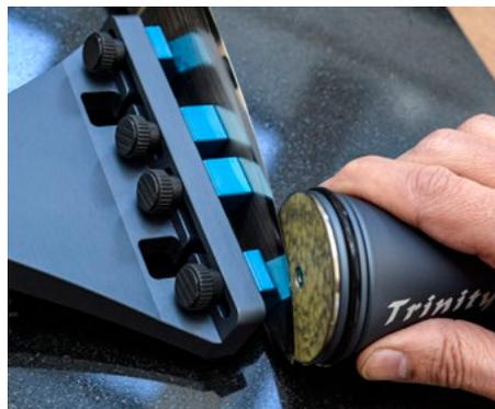
Zur Spitze hin kann der Schleifer ohne Widerstand der Krümmung der Schneide folgen und um die Kurve fahren.
