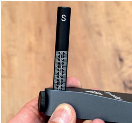
An der vertikalen Stange kann man den effektiven Schärfwinkel einstellen. Die S-Skala ist bei besonders hohen Klingen maßgeblich (mit passenden Magnethaltern), die N-Skala für normale Klingen, die mit der Schneide nach oben fixiert werden.
