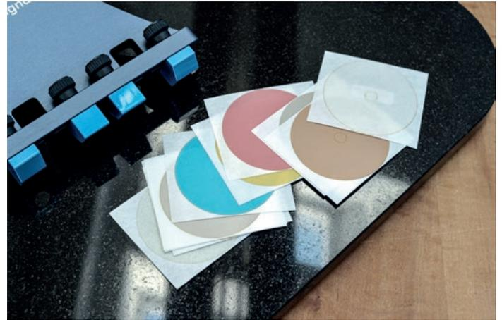
Die eigentlichen Schärfelemente sind Kunststofffolien, die auf die Trägerplatten des Systems geklebt werden.
