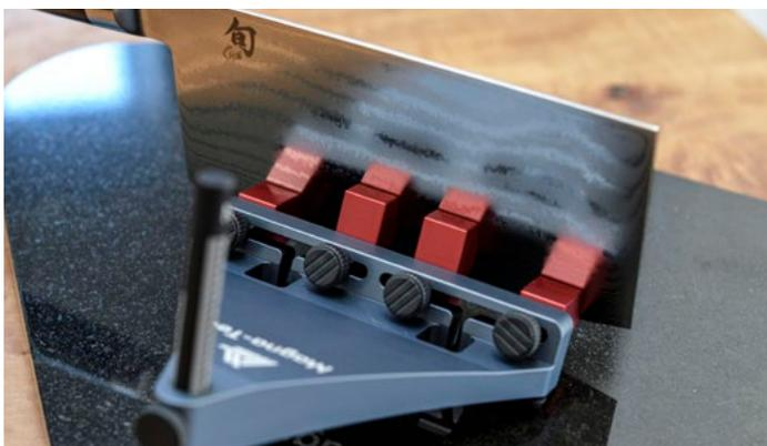
Besonders hohe Klingen wie bei diesem chinesischen Hackmesser werden mit speziellen Haltern mit der Schneide nach unten fixiert.
