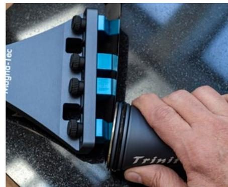
Hier sieht man gut, wie der Schleifer am Ende des WegZs einen deutlichen Winkel im Vergleich zur Grundplatte aufweist.
