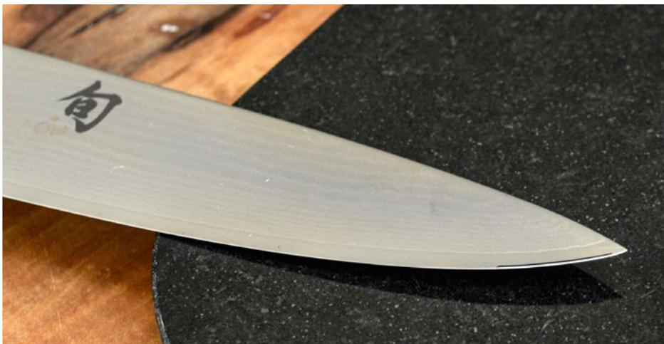
Wenn der Schleifwinkel richtig eingestellt ist (wie hier anhand der Farbmarkierung zu sehen), wird nur die Schneidfase materialschonend geschliffen. Die Schneide muss nicht in einen anderen Winkel umgeschliffen und an das Schärfergerät angepasst werden.
